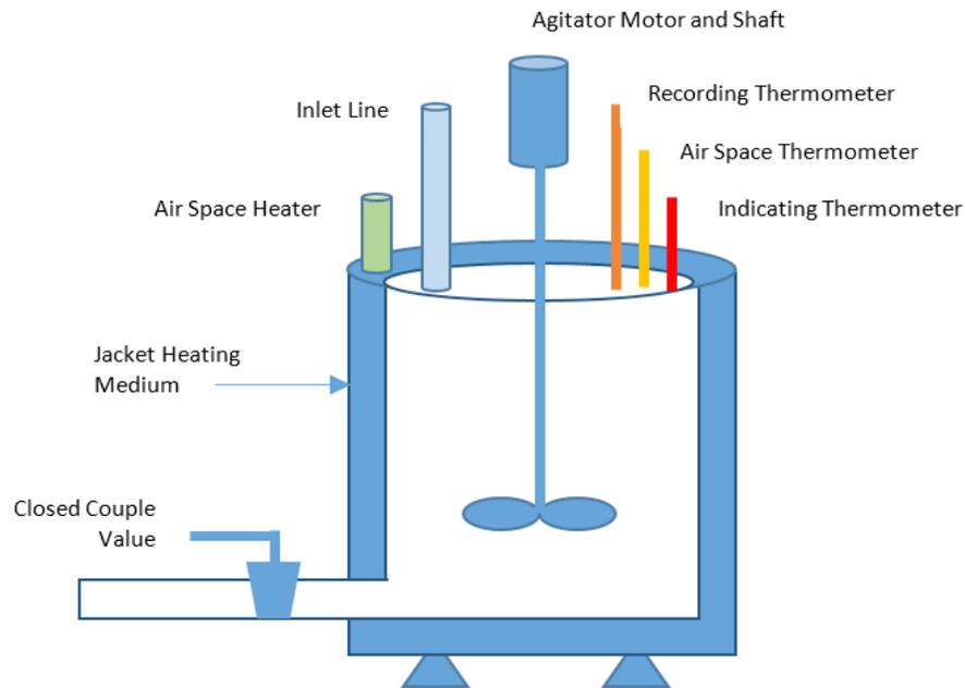
Fig: Batch Pasteurization
